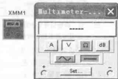
图 3.20 数字万用表在电路中的符号及其控制面板
