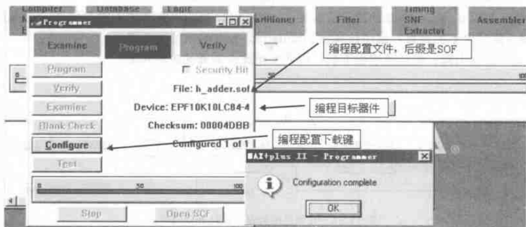
图 11.21 向 EPF10K10 下载配置文件
